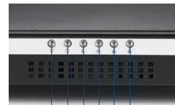
Power | Temp. | LAN1 HDD | Fan | LAN2
